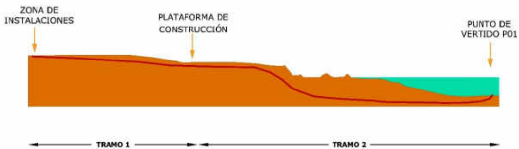
Figura 8.5.-Esquema del emisario completo.
