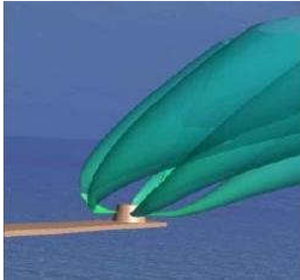
Figura 8.3.- Salida gráfica tridimensional del efluente por el difusor multiorificio
