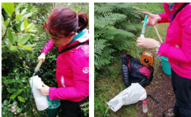
Figura 52. Muestreo y filtrado de agua del sondeo L0201 para análisis químico
