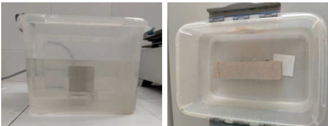
Figura 7. Alzado y planta del dispositivo de ensayo para el test UNE-EN-15863.
