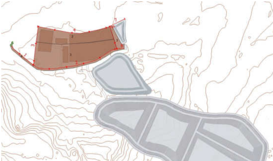
Figura 3.18.- Mapa de la red de drenaje de las aguas de contacto en las instalaciones (canales de drenaje en rojo, punto de bombeo en verde).
