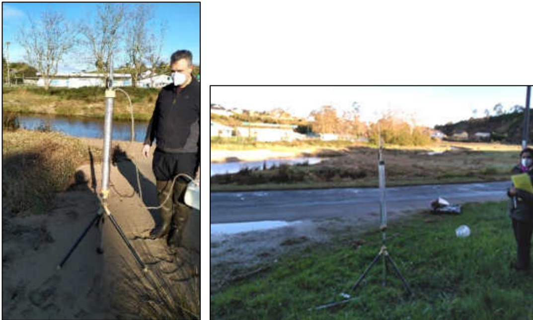
Figura 48. Medida de permeabilidad in situ en dos zonas próximas de depósitos aluviales; izda.: depósitos arenosos actuales del río Anguileiro; dcha.: material aluvial con vegetación a unos 25 m del punto anterior (éste se ve al fondo)
