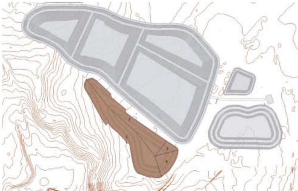
Figura 3.8.- Subcuencas de las aguas de contacto en escombrera de material de excavación SW
