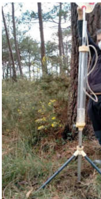
Figura 45. Instalación del permeámetro en una zona de recubrimiento de rasa
