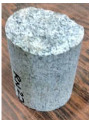
Figura 41. Testigo de granodiorita enviado a Holanda para determinación de permeabilidad
