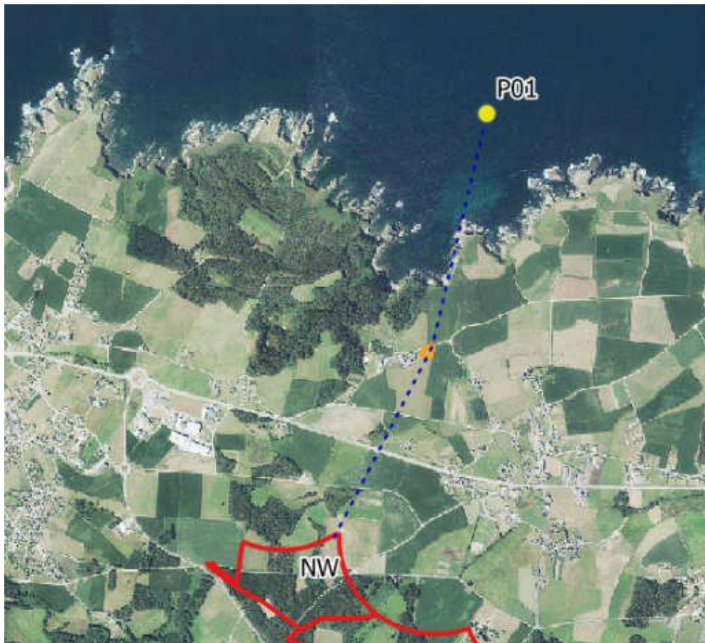
Figura 2.2.- Diseño final para la construcción del emisario.
