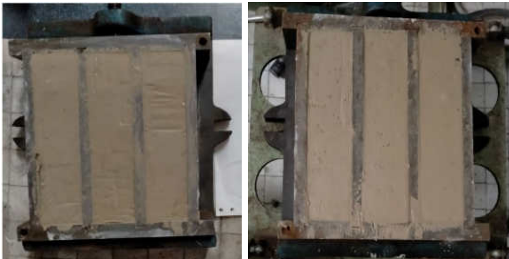
Figura 6. Elaboración de las probetas de la mezcla propuesta.
