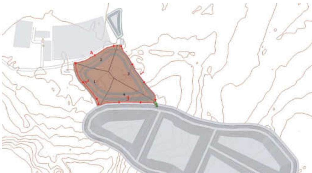
Figura 3.15.- Mapa de la red de drenaje de las aguas de contacto en la escombrera de estériles de mina (canales de drenaje en rojo, punto de bombeo en verde).
