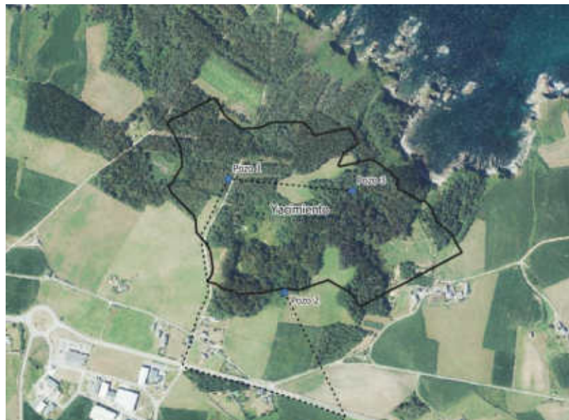
Figura 3.1.- Localización de los tres pozos de depresión del nivel freático y sus tuberías de conducción en la zona del yacimiento.
